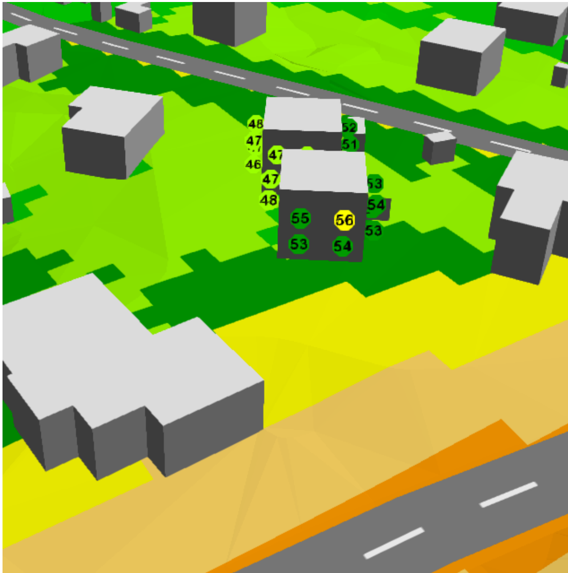
Kuva 3 Julkisivuille kohdistuvat korkeimmat keskiäänitasot ennustetilanteessa 2040 päivällä.
